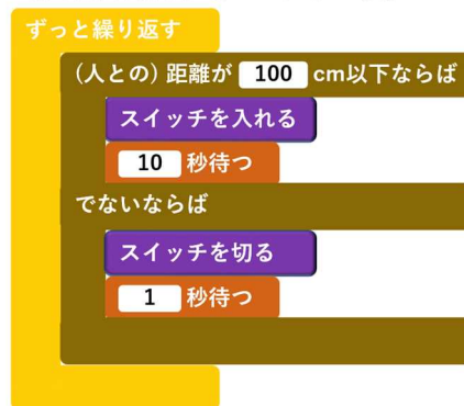
図3-8 人を感知するセンサで通電を制御するプログラムの例
